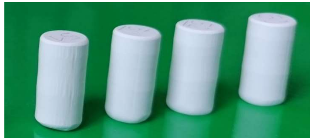
Slika 6.2 Sirovci \text{Al}_2\text{O}_3 nakon hladnog izostatičkog prešanja
