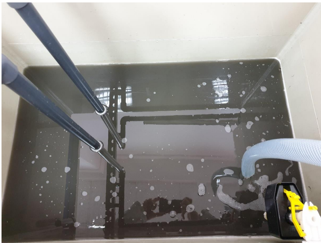
Slika 7. Pogled u spremnik sirove vode s potopnom membranom
