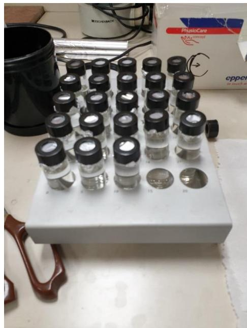
Slika 16. Pripremljeni uzorci za TOC analizu
