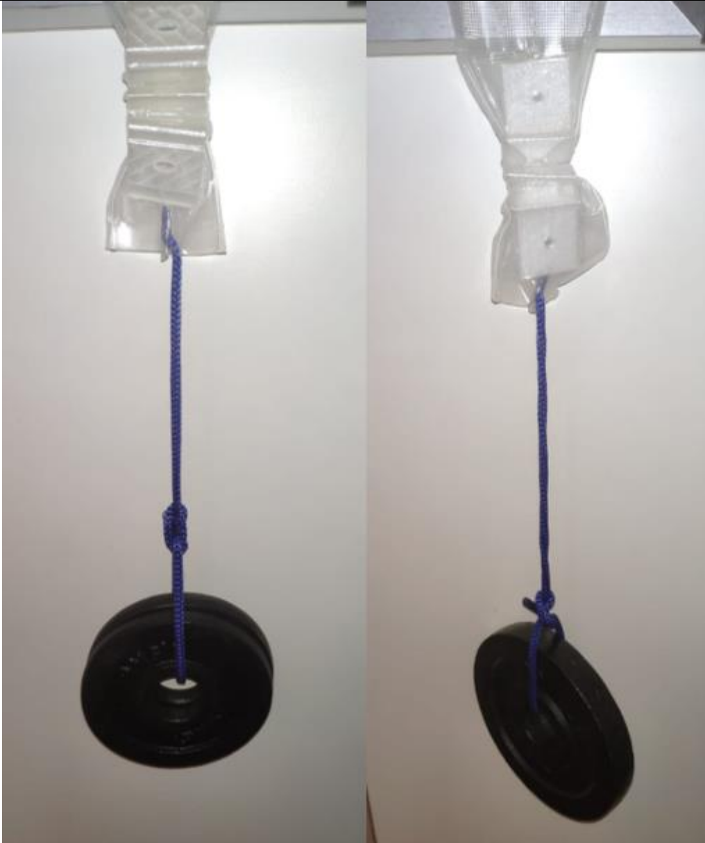
Slika 43 – Test umjetnih mišića s utezima
