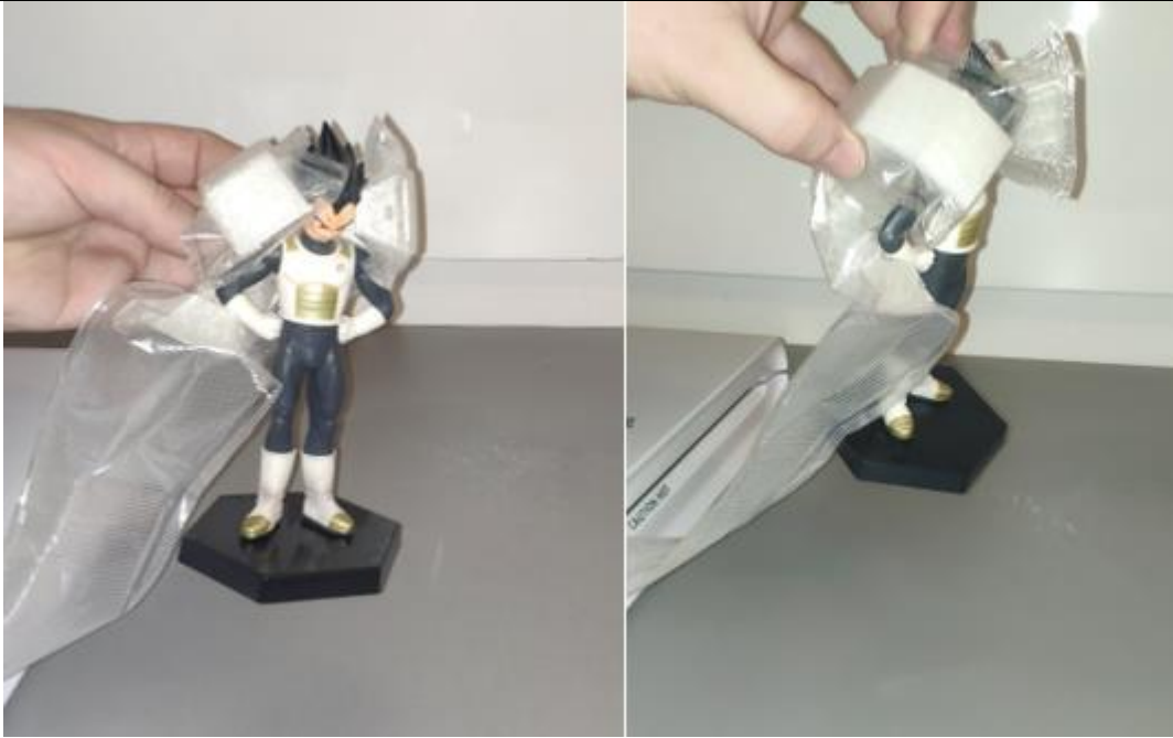
Slika 57 – Hvatanje veće figurice origami prihvatnicom
