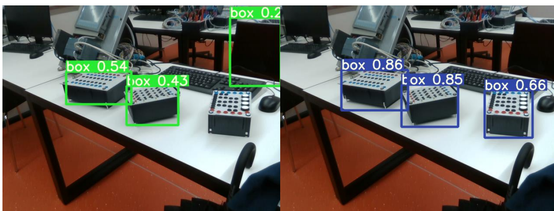
Slika 20. Usporedba rezultata detekcije objekta nakon treniranja mreže sa 130 (lijevo) i 500 epoha (desno)
