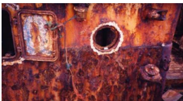
Slika 3. Opća korozija dijela broda [5]
