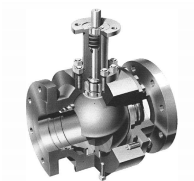
Slika 1.3: Kuglasti regulacijski ventil [1]
