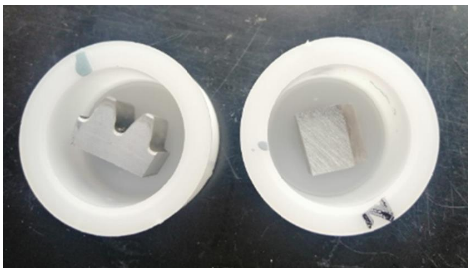
Slika 17. Uzorci u kalupima prije ulijevanja polimerne mase
