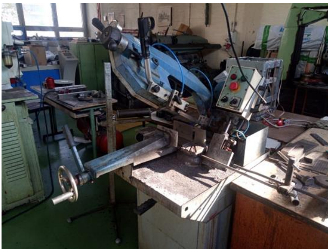
Slika 14. Strojna pila na kojoj su izrezani uzorci
