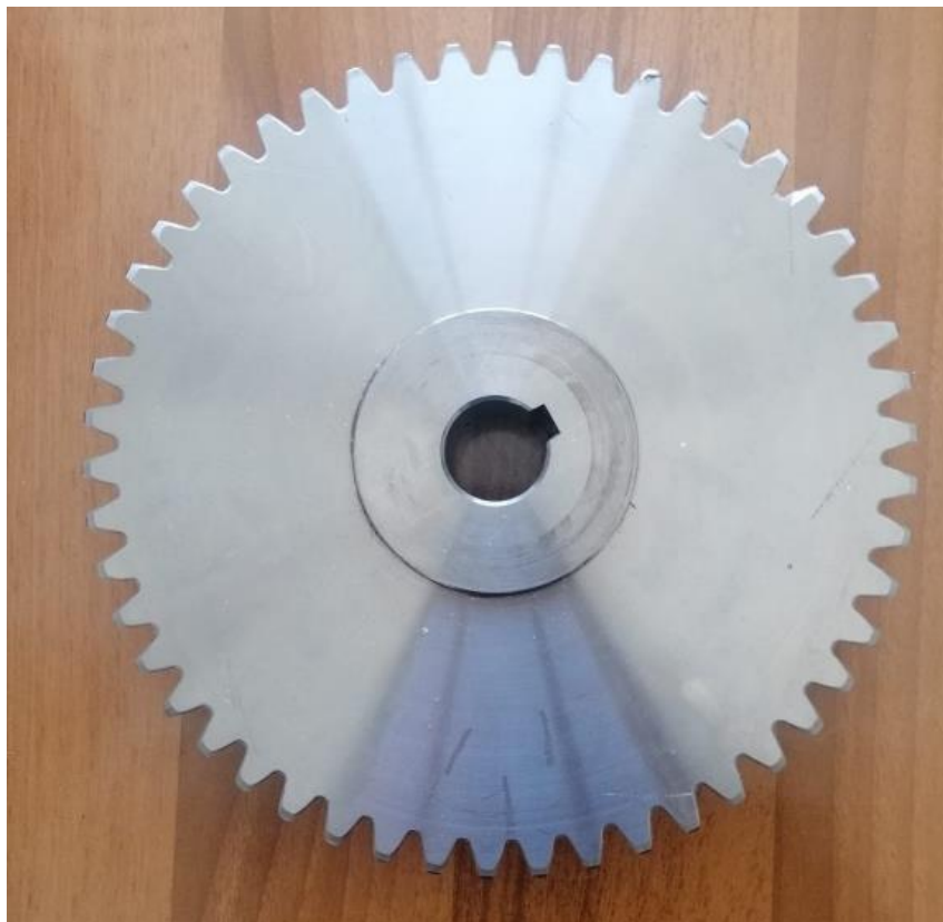
Slika 11. Analizirani zupčanik izuzet iz botomera
