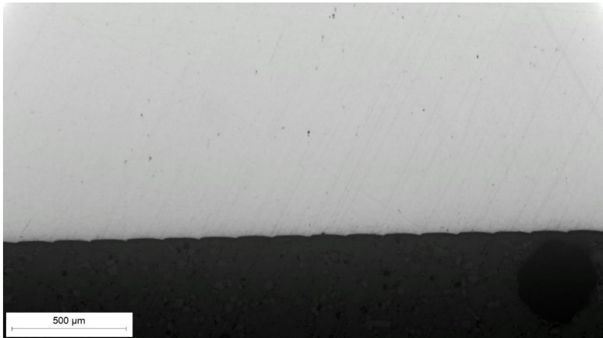
Slika 31. Polirana površina uzorka 2 u rubnom sloju
