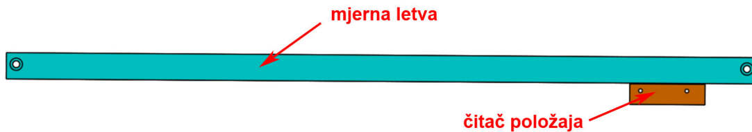
Slika 48: Model mjerne letve s čitačem položaja
