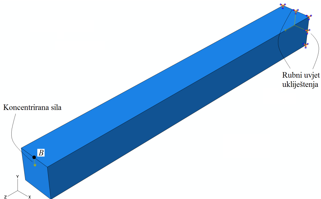
Slika 3.18. Prikaz geometrije modela, rubnih uvjeta i opterećenja
