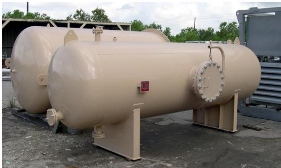
**Slika 1.2. Primjer tlačnog spremnika [7]**
