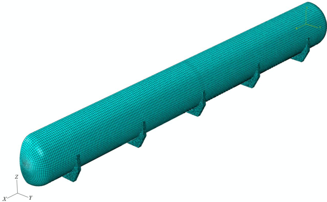
Slika 6.52. Mreža konačnih elemenata na cijelome modelu
