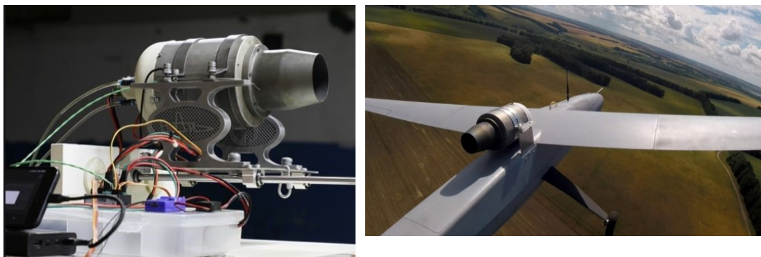
Slika 17. Plinsko-turbinski motor MGTD-20 [35]
