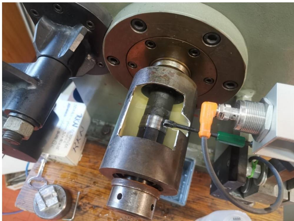
Slika 25. Postavljanje dodatka za ispitivanje u vlažnom stanju
