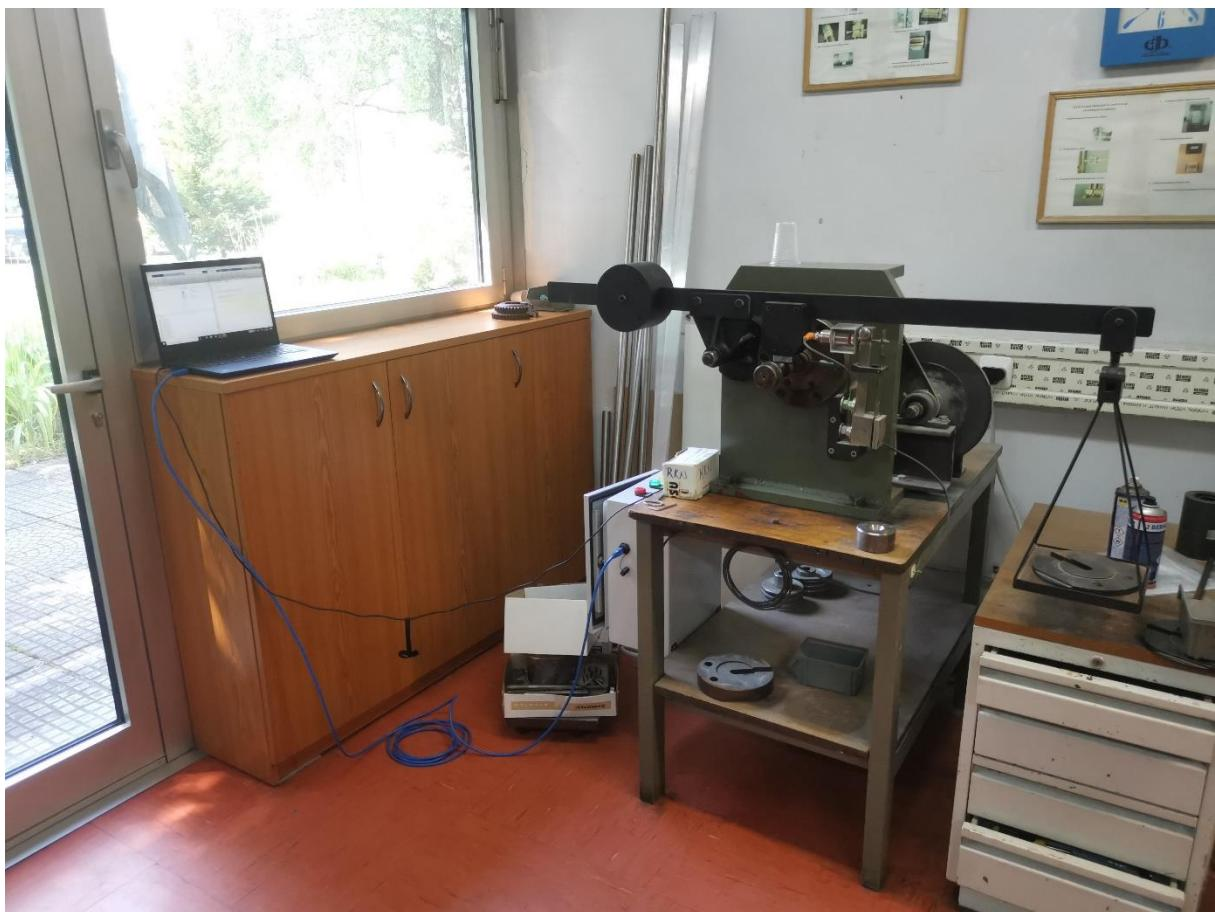
Slika 17. Automatizirani uređaj za ispitivanje „block on ring“
