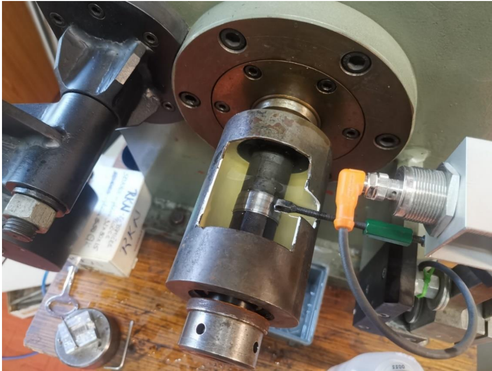
Slika 25. Postavljanje dodatka za ispitivanje u vlažnom stanju
