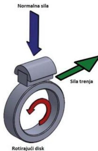
Slika 6. Shematski prikaz metode „ block on ring “ [6]
