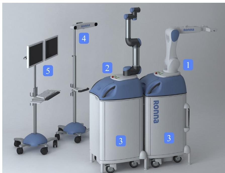
Slika 1.1: Prikaz sustava RONNA G3 s komponentama: (1) glavni robot, (2) pomoćni robot, (3) univerzalna mobilna platforma, (4) optički sustav za praćenje i (5) softversko sučelje za upravljanje i planiranje.
