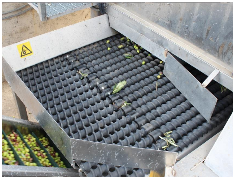
Slika 2.6. Navojne šipke za odstranjivanje većeg lišća kod uređaja Clemente Tornado 1 [14]
