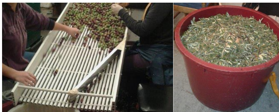
Slika 1.9. Čišćenje (lijevo), otpadno lišće (desno) [8]
