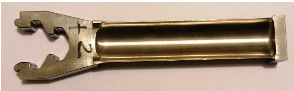
Slika 18 Lopatica rotora parne turbine prije rezanja - 2
