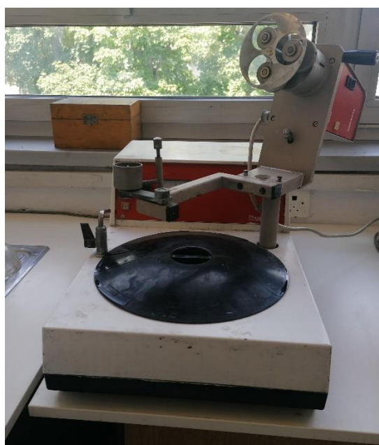
Slika 22 Uredaj za poliranje Struers DAP-V
