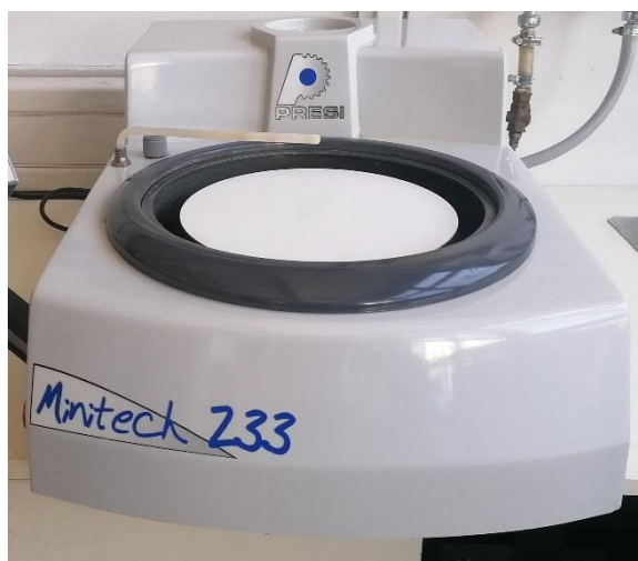
Slika 21 Uredaj za brušenje PRESI Minitech 233
