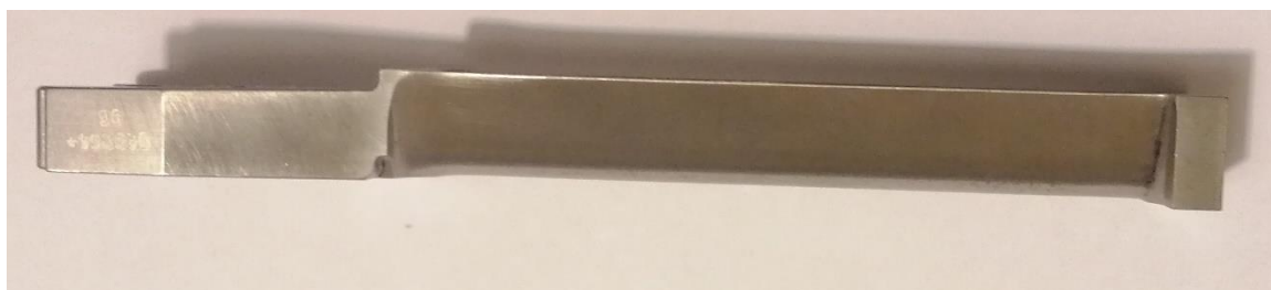
Slika 19 Lopatica rotora parne turbine prije rezanja - 3
