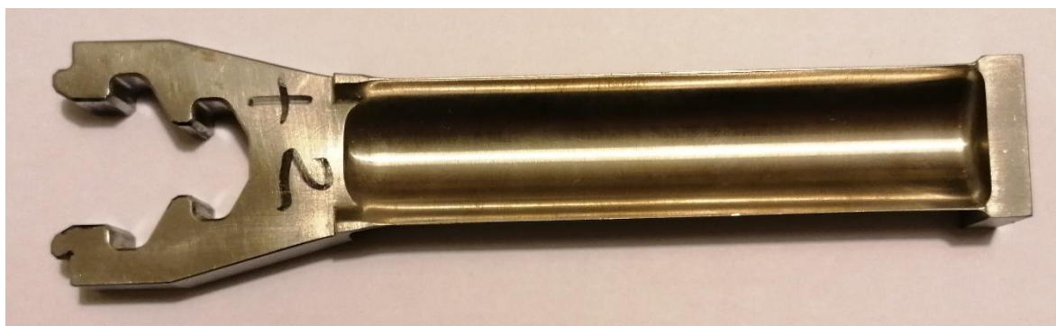
Slika 18 Lopatica rotora parne turbine prije rezanja - 2
