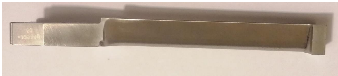
Slika 19 Lopatica rotora parne turbine prije rezanja - 3
