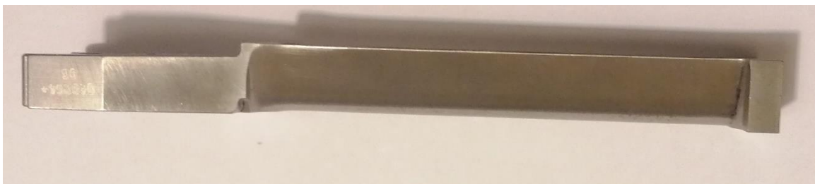
Slika 19 Lopatica rotora parne turbine prije rezanja - 3
