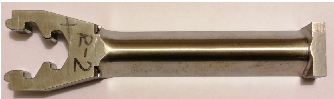
Slika 17 Lopatica rotora parne turbine prije rezanja - 1
