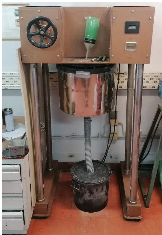
Slika 29 Uređaj za ispitivanje otpornosti materijala na eroziju česticama suhim pijeskom
