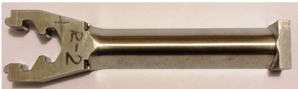
Slika 17 Lopatica rotora parne turbine prije rezanja - 1
