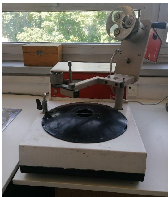
Slika 22 Uredaj za poliranje Struers DAP-V
