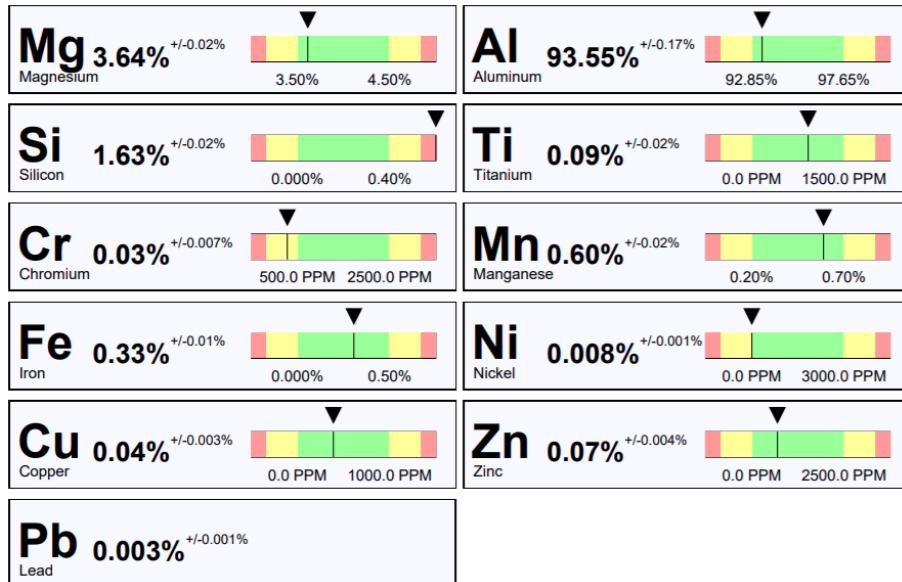
Slika 38. Rezultati ispitivanja kemijskog sastava na mjerenom području 2
