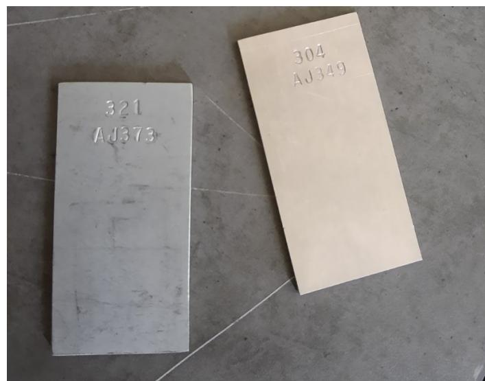
Slika 35. Testne pločice legura bliskog kemijskog sastava
