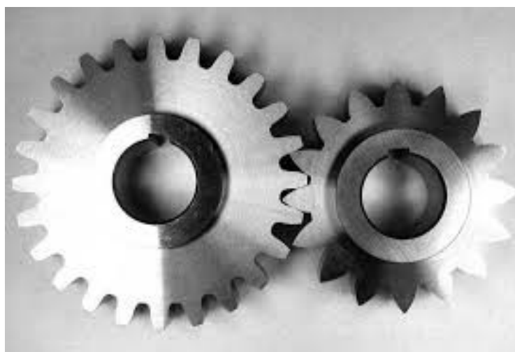
Slika 6 – FZG standardni ispitni zupčanički par Tip A [25]
