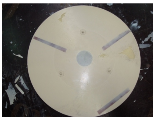
Slika 8.13. Prikaz upotrebe odstoynika pri izradi sendvič ploče
