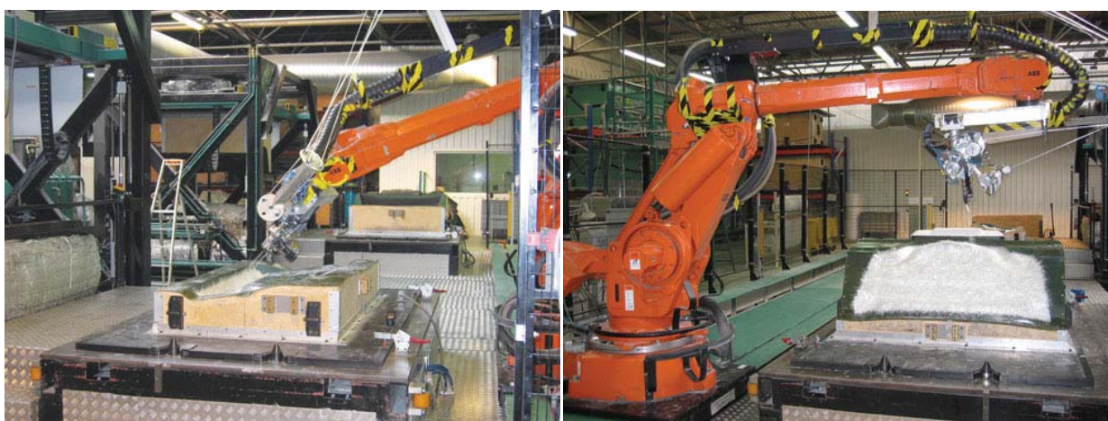
Slika 6.2. Prikaz upotrebe automatizirane robotske ruke za postupak štrcanja vlakana [26]
