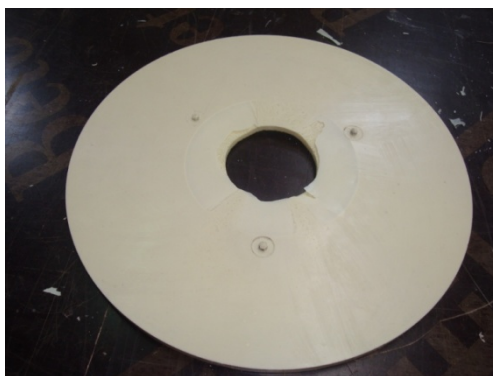
Slika 8.12. Prikaz sendvič konstrukcije dobivene centrifugalnim lijevanjem
