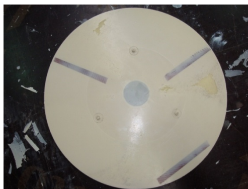
Slika 8.13. Prikaz upotrebe odstoynika pri izradi sendvič ploče
