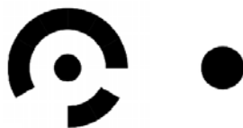
Slika 7.14. Kodirana (lijevo) i nekodirana (desno) mjerna točka
