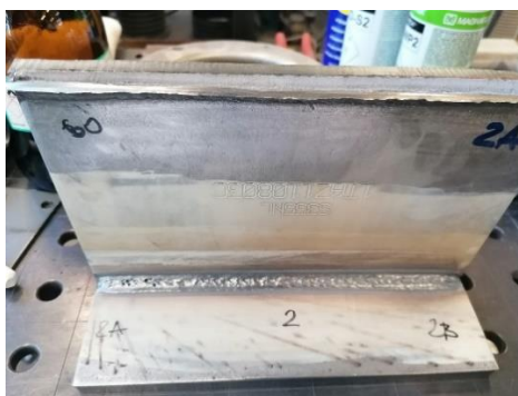
Slika 52. Podjela uzorka 2 na dijelove za ispitivanje
