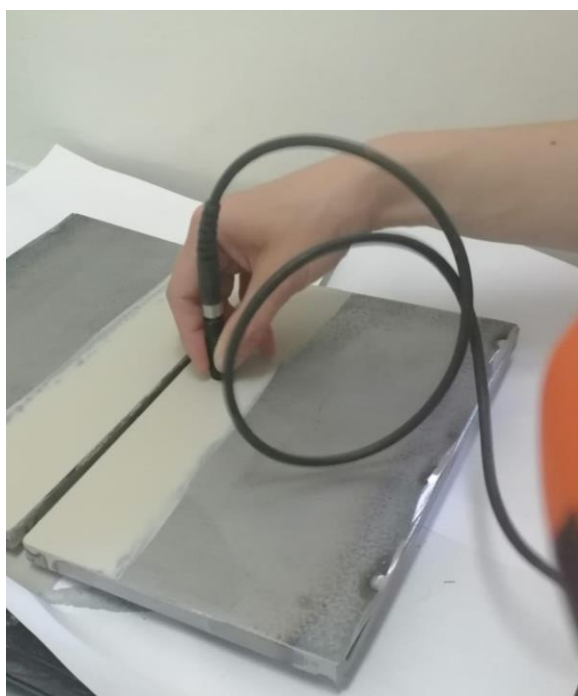
Slika 37. Postupak mjerenja debljine premaza
