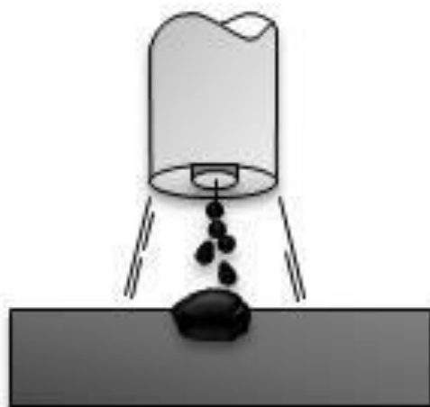
Slika 15. Shematski prikaz za prijelazni luk[21]
