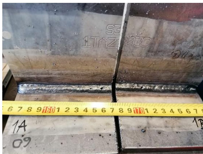
Slika 54. Uzorci 1A i 1B za ispitivanje savijanjem
