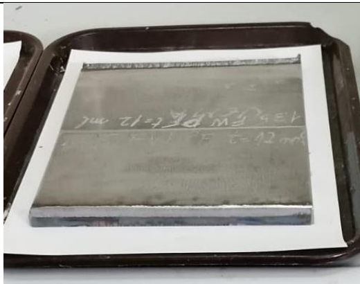
Slika 34. Pripremljene ploče za nanošenje temeljnog premaza
