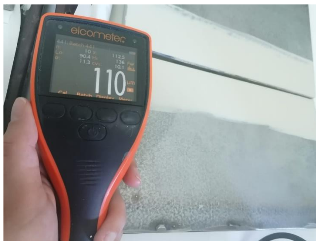
Slika 38. Prikaz rezultata mjerenja debljine pomoću uređaja Elcometer 456/4
