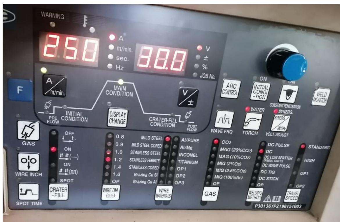
Slika 42. Postavljeni parametri kod MAG zavarivanja
