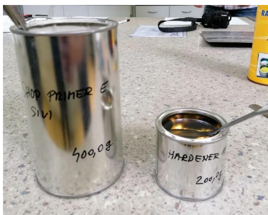
Slika 30. Dvokomponentni temeljni premaz SHOP primer E
