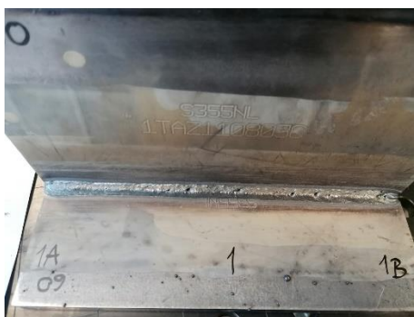
Slika 51. Podjela uzorka 1 na dijelove za ispitivanje
