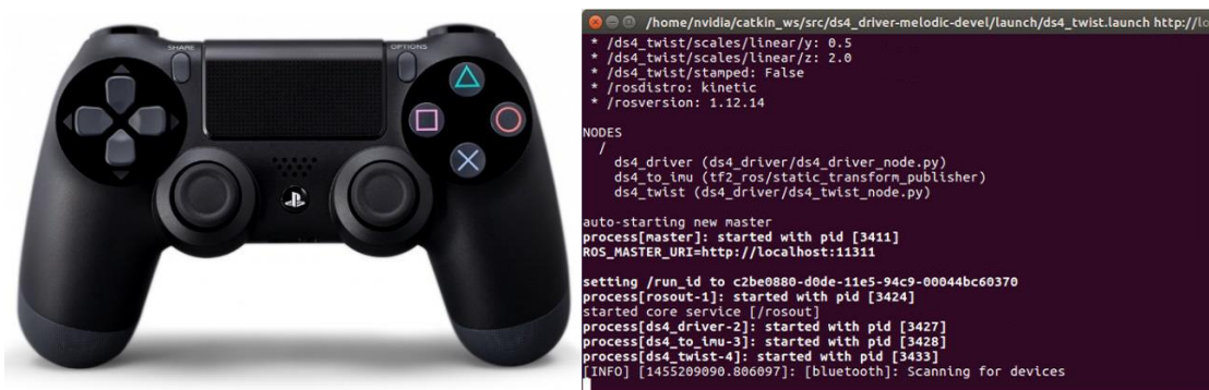
Slika 23. Prikaz Playstation 4 upravljača-lijevo i pokretanje ds4_driver čvora-desno
