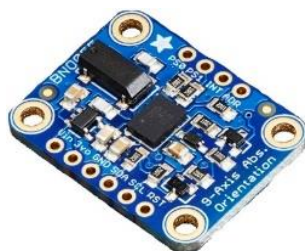
Slika 13. Prikaz IMU-a Bosch BNO055 [10]
