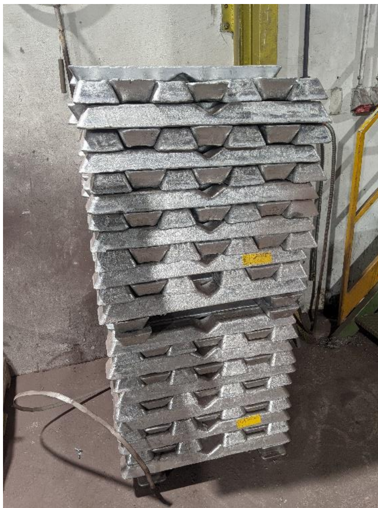
Slika 8. Novi ingoti legure AlSi12
