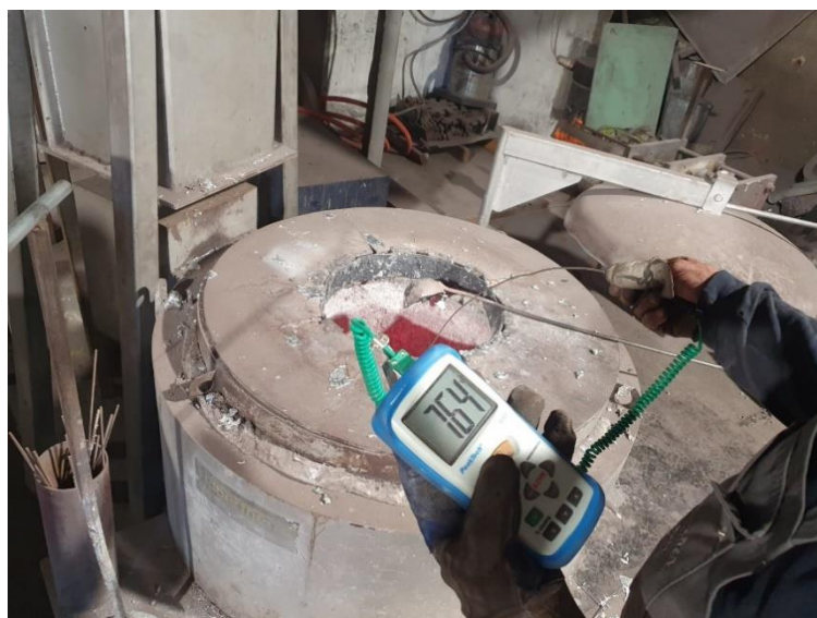
Slika 19. Provjera temperature taline u peći
