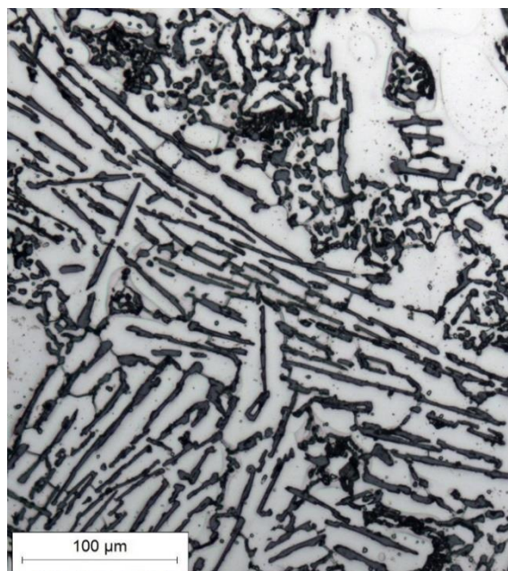
Mikrostruktura pete obrađene AISi12 legure (nagrižena) -200x
