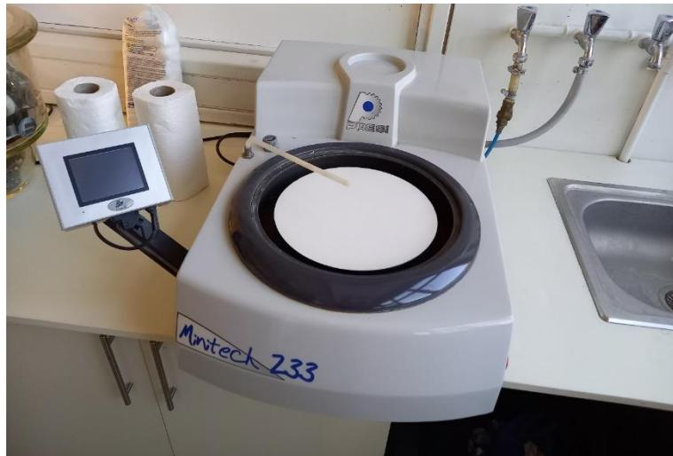
Slika 29. Uređaj za ručno poliranje *Presi Minitech 233*
