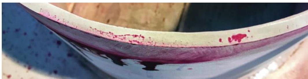
**Slika 18.** Ispitivanje penetrantom crvenog pigmenta [21]
