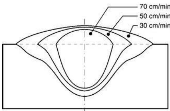
**Slika 5.** Utjecaj brzine zavarivanja na izgled zavara [4]
