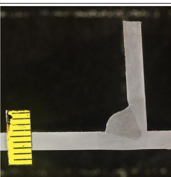
Svi zavareni probni uzorci, neovisno o korištenim parametrima, imaju postignutu intenzivniju penetraciju u odnosu na postojeću tehnologiju zavarivanja zbog korištenja trokomponentnog plina *Ferroline C6X1* u kombinaciji s tanjim dodatnim materijalom debljine 1,0 mm. Zahvaljujući boljoj postignutoj penetraciji može se tolerirati manja postignuta visina zavara *a*.
