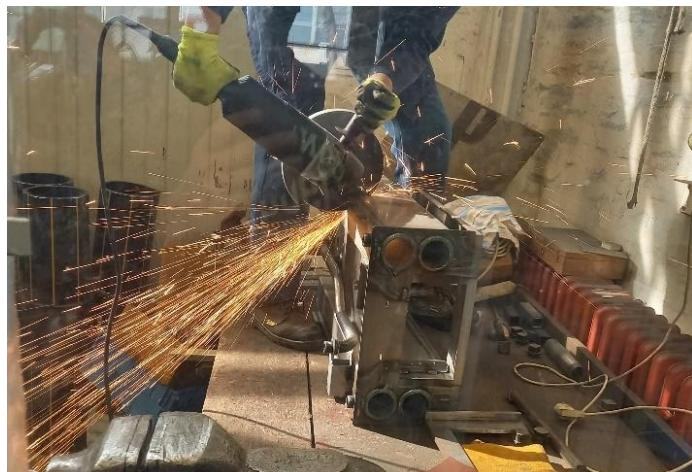
**Slika 25.** Razrezivanje kotla na veće dijelove zbog provođenja ispitivanja penetrantom
