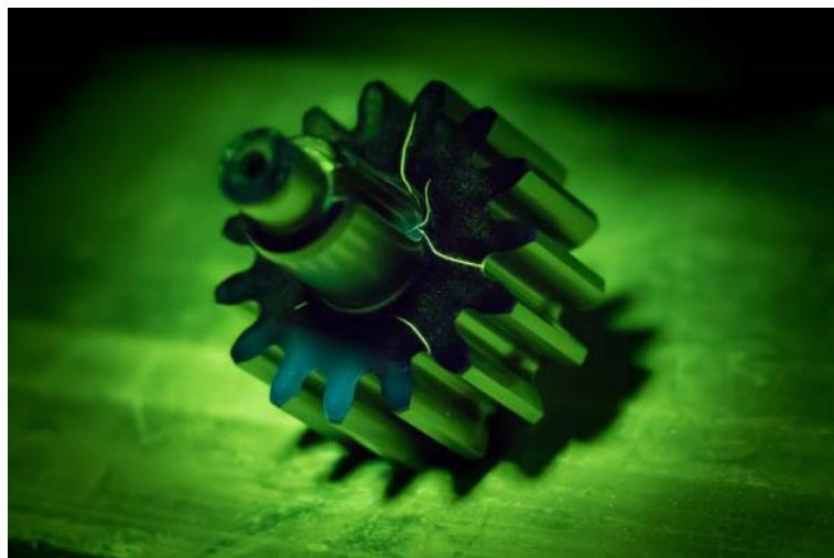
Slika 19. Ispitivanje fluorescentnim penetrantom [22]
