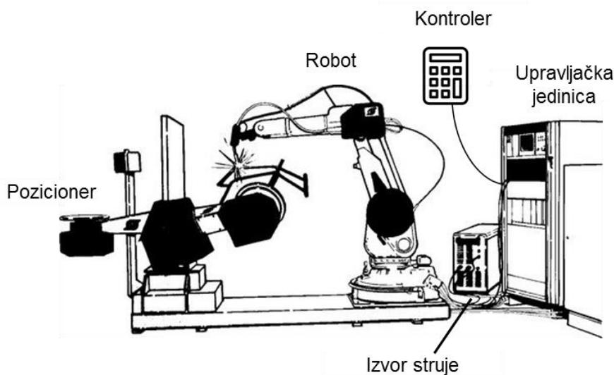
**Slika 15.** Robotska stanica za MAG zavarivanje [4]
