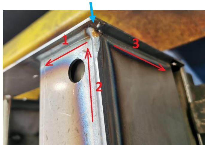
Slika 30. Raspored vođenja zavara (postojeća tehnologija zavarivanja)[24]
