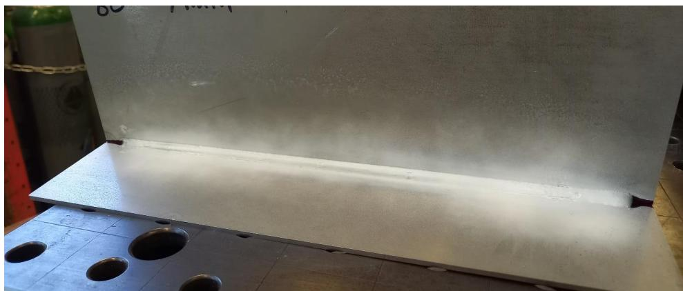
**Slika 33.** Ispitivanje probnog uzorka A penetrantom
