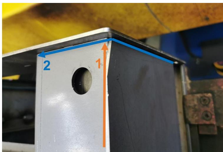
Slika 31. Primjer ispravnog rasporeda vođenja zavara na postojećem primjeru[24]
