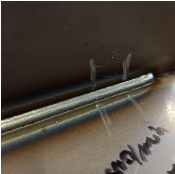
Nakon zavarivanja uzoraka, uzorak A je ispitana penetrantom (Slika 33). S obzirom da nije došlo do propuštanja navedenog uzorka zaključeno je da nema potrebe za ispitivanjem ostalih uzoraka.
