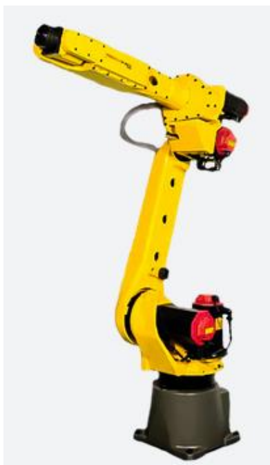
Slika 46. Šesteroosni robot Fanuc M-20iA/35 [18]
