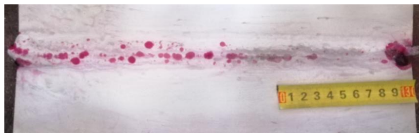
Slika 52. Lice zavora sa nanesenim penetrantom i razvijачem
