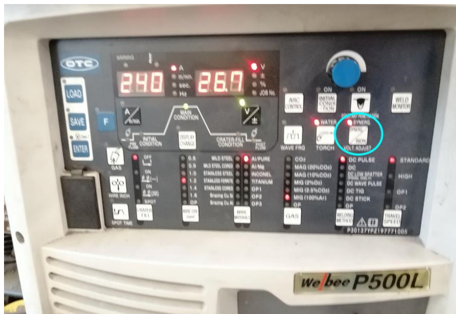
Slika 39. Sučelje za podešavanje načina rada i parametara na izvoru struje
