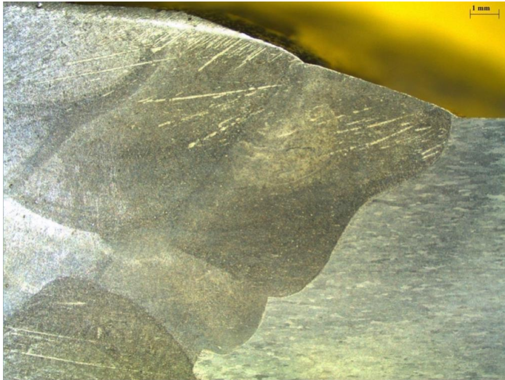
Slika 59. Makroizbrusak lica zavara desno
