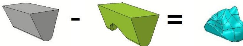
**Slika 6.17. Postupak dobivanja konačnog modela ispuna**
