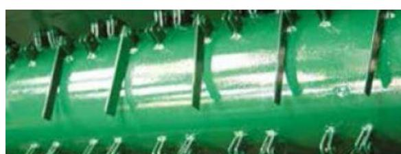
Slika 13. Vertikalni rezni alat [14]
