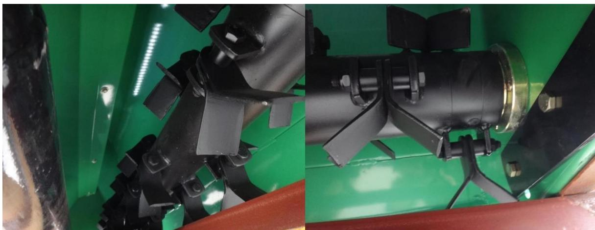
Slika 57. Rotor s Y-noževima [33]
