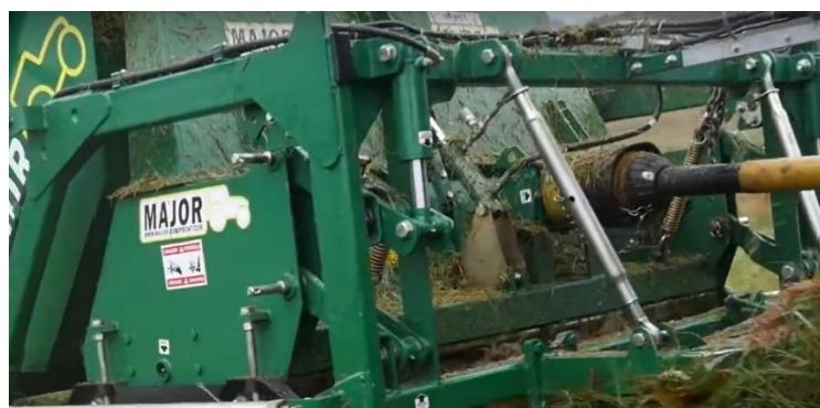
**Slika 67. Hidraulički cilindar za regulaciju visine rezanja 37**
