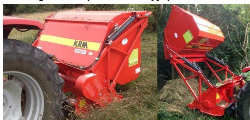
**Slika 51. KRM kosilica s spremnikom [32]**
