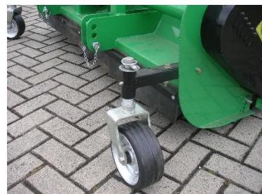
**Slika 58. Kotač za regulaciju visine i zaštitna guma [33]**
