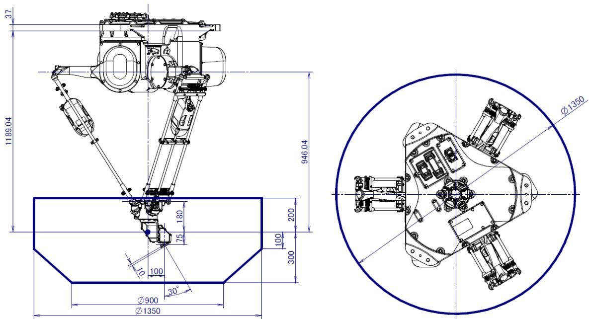
Slika 25. Dimenzije djelokruga robota, [11]
