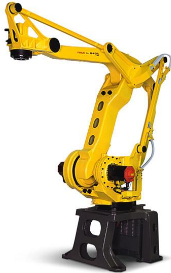
Slika 8. 4-osni robot Fanuc M-410iC/185
