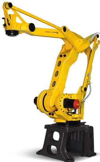
**Slika 8. 4-osni robot Fanuc M-410iC/185**
