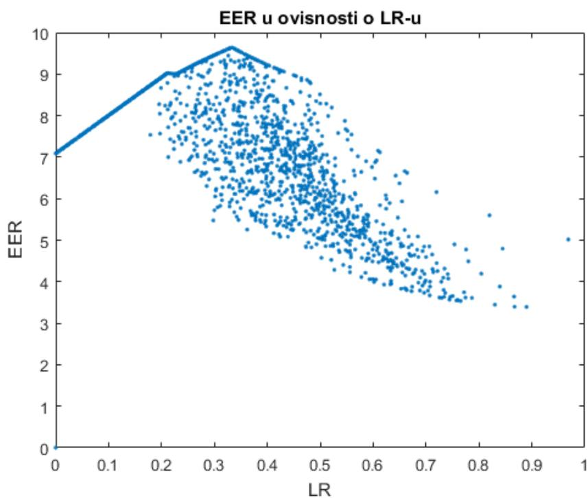
Slika 35. Vrijednost EER-a u ovisnosti o omjeru opterećenja
