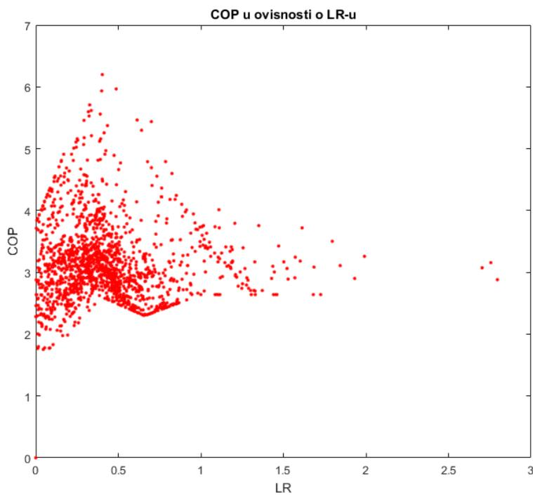
Slika 20. Vrijednost COP-a u ovisnosti o omjeru opterećenja
