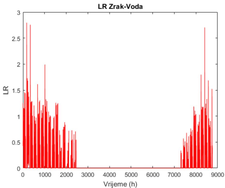
Slika 17. Omjer dostupnog i potrebnog kapaciteta za grijanje dizalicom topline zrak-voda
