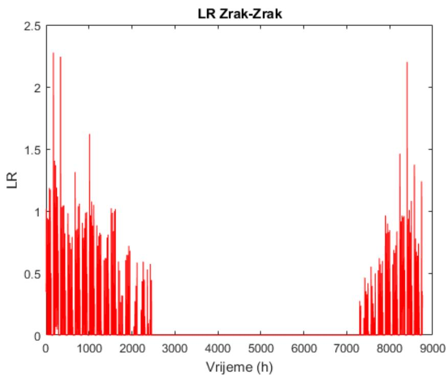
Slika 27. Omjer dostupnog i potrebnog kapaciteta za grijanje dizalicom topline zrak-zrak
