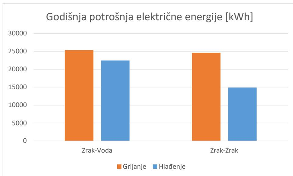
Slika 37. Prikaz potrebne električne energije za dizalice topline
