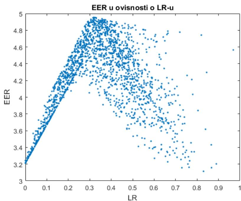
Slika 25. Vrijednost EER-a u ovisnosti o omjeru opterećenja
