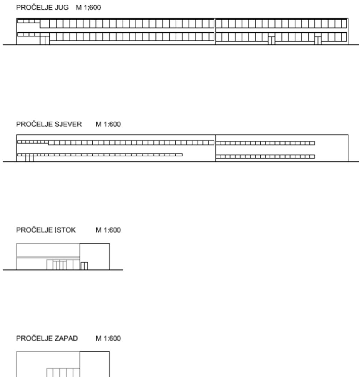
Slika 5. Pročelja nZEB referentne zgrade za obrazovanje
