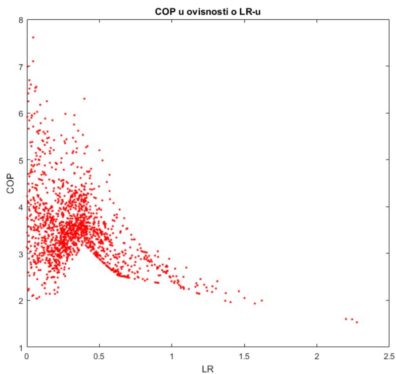
Slika 30. Vrijednost COP-a u ovisnosti o omjeru opterećenja
