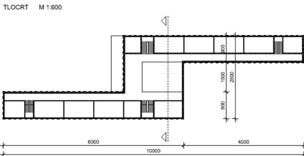
**Slika 3. Tlocrt nZEB referentne zgrade za obrazovanje**
