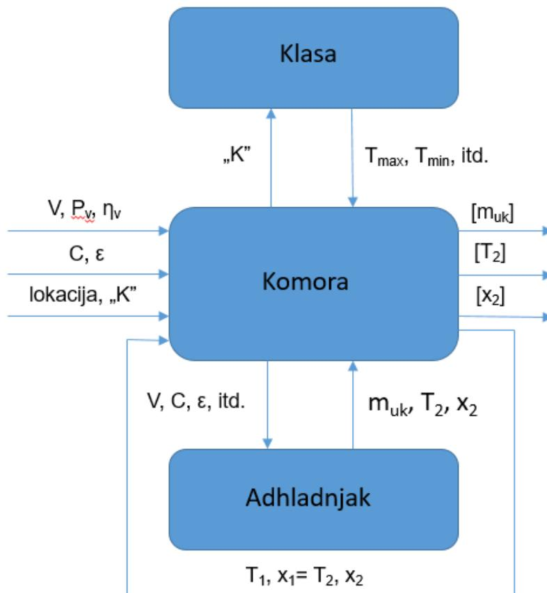
**Slika 14. Blok shema s ulaznim i izlaznim podacima za potprogram „Komora“**
