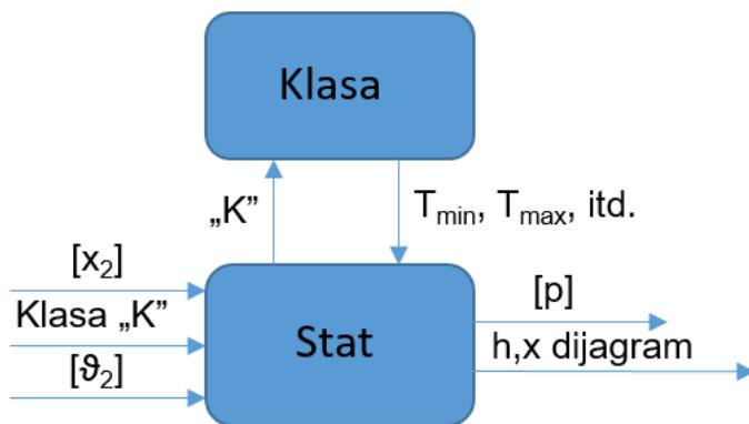
**Slika 13. Blok shema s ulaznim i izlaznim podacima potprograma „Stat“**
