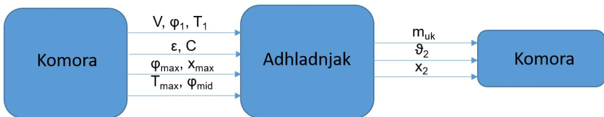
**Slika 12. Blok shema s ulaznim i izlaznim podacima potprograma „Adhladnjak“**
