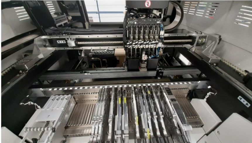
Slika 2. Pick & place stroj elektroničkih komponenata
