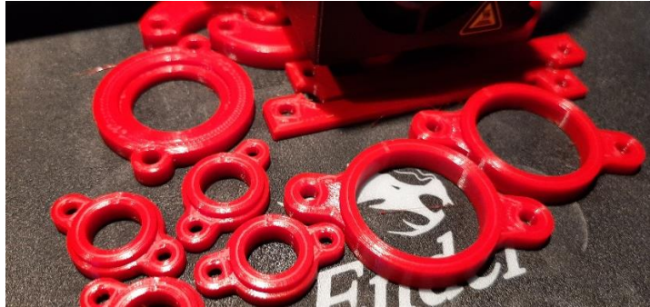
Slika 29. 3D printanje osigurača ležišta ležajeva
