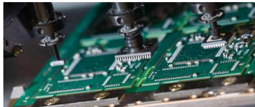
Slika 4. Pokupljanje komponenti vakuumskom mlaznicom [1]
