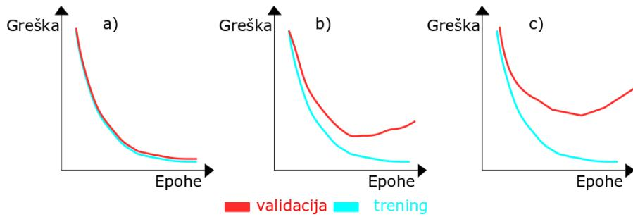
Slika 62. Prikaz *overfitting-a*: a) optimum, b) i c) *overfitting*
