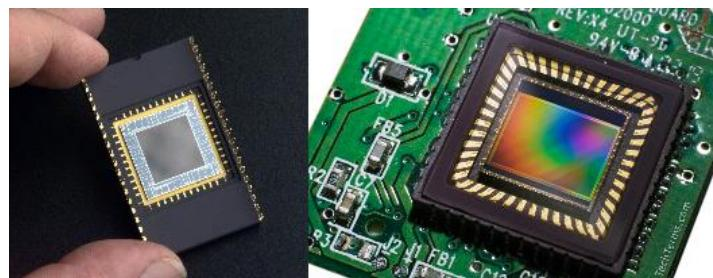
Slika 9. CCD senzor (lijevo) i CMOS (desno)
