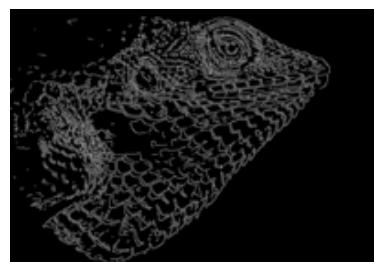
Slika 23. 5. korak *Canny edge* detektora
