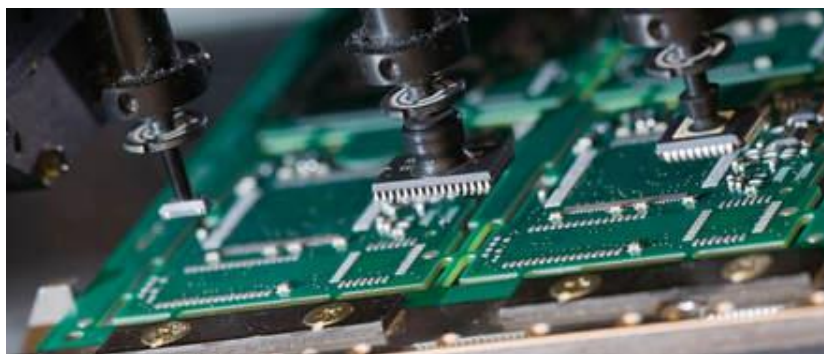
Slika 4. Pokupljanje komponenti vakuomskom mlaznicom [1]
