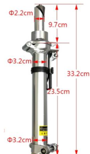
Slika 30. Nastavak za spajanje vilice s upravljačem [27]
