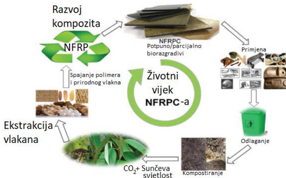
Slika 5. Životni vijek kompozitâ polimerne matrice ojačanih biološkim vlaknima [11]
