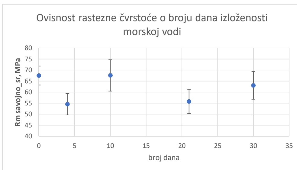
Slika 39 Srednje aritmetičke sredine vrijednosti rastezne čvrstoće i njihove standardne devijacije ispitnih tijela u ovisnosti o broju dana izloženosti morskoj vodi
