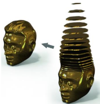
Slika 4.1. Princip aditivnih postupaka proizvodnje [6]
