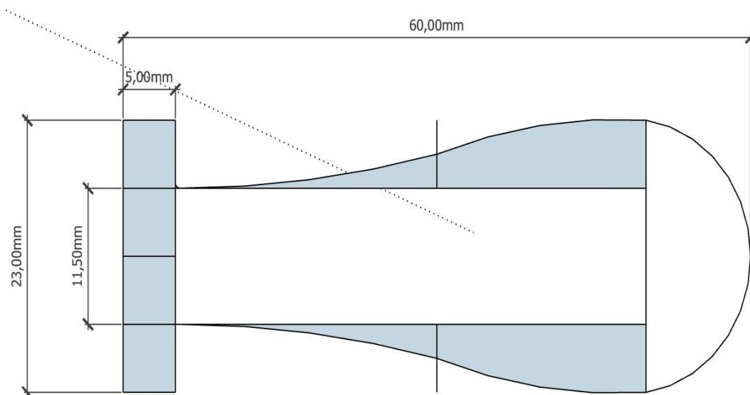
Slika 16. Dimenziije lopatica robotskog ventilatora
