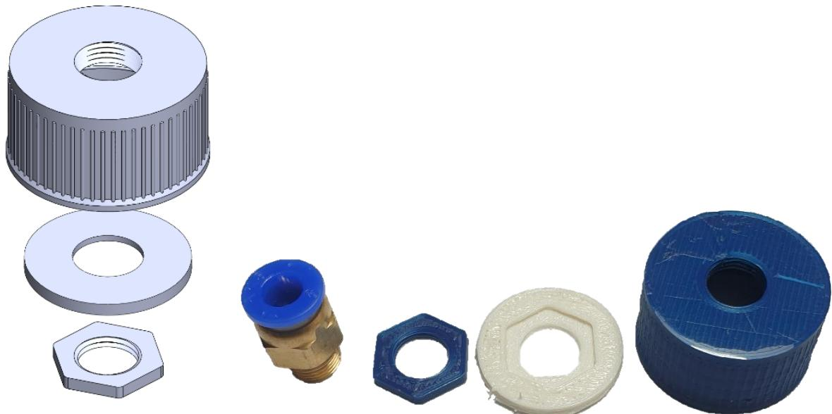
**Slika 57.** 3D model čepa (lijevo), isprintani dijelovi (desno)
