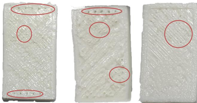
Slika 63. Poroznost na testnim uzorcima
