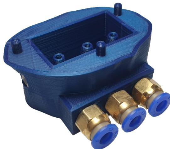
Slika 61. Nastavak s pneumatskim priključcima
