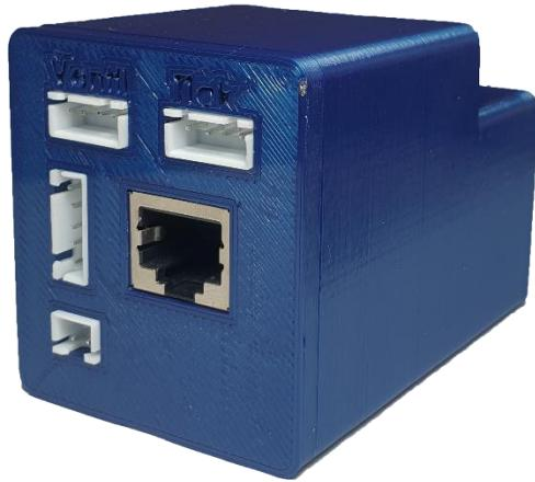
Slika 56. Kućište za mikrokontroler
