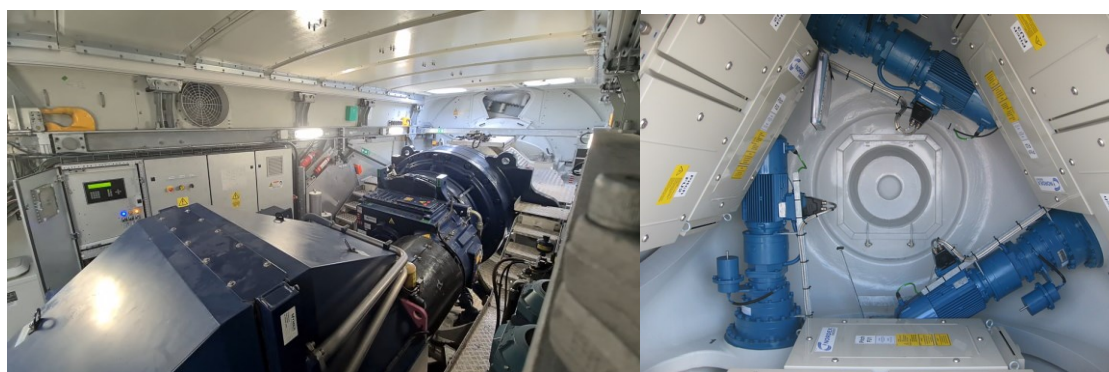
Slika 2.7. Unutrašnjost gondole (lijevo) [9] i glave rotora (desno) [10]
