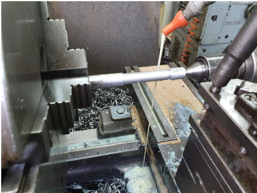
Slika 35. Prikaz obrade epruvete na tokarilici
