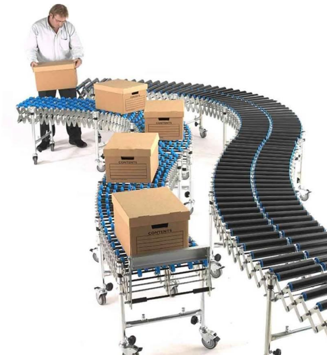
Slika 46. Fleksibilni konvejer za lakše prilagođavanje radnom mjestu [19]
