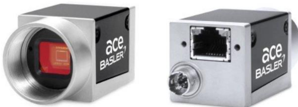
Slika 77. Kamera Basler acA2500 – 14gc [22]
