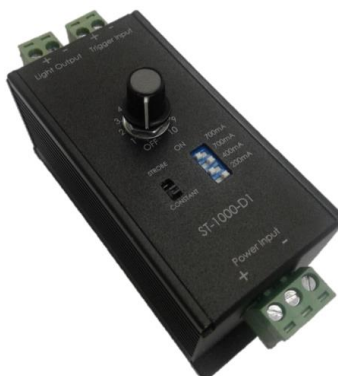
Slika 51. Kontroler za upravljanje industrijskim osvetljenjem [14]
