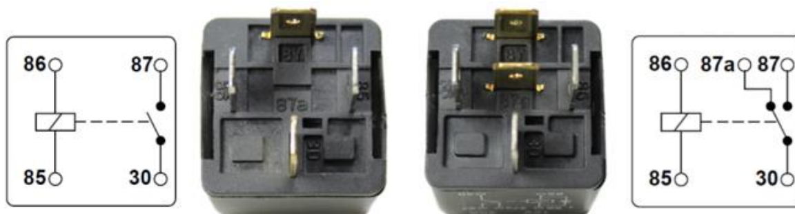
Slika 2. Releji s četiri pina (lijevo) i s pet pinova (desno)
