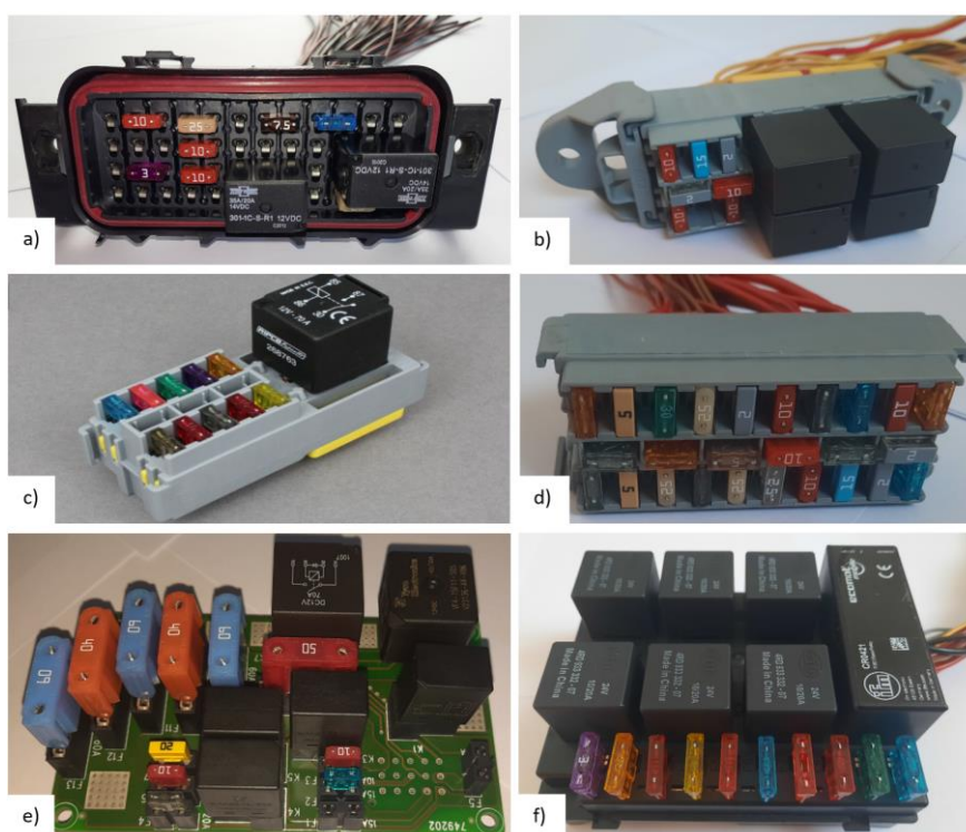
Slika 4. Razmatrana kućišta osigurača
