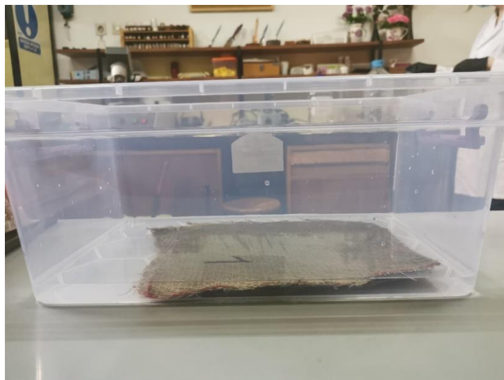
Slika 11. Namakanje lanenih vlakana u natrijevoj lužini.
