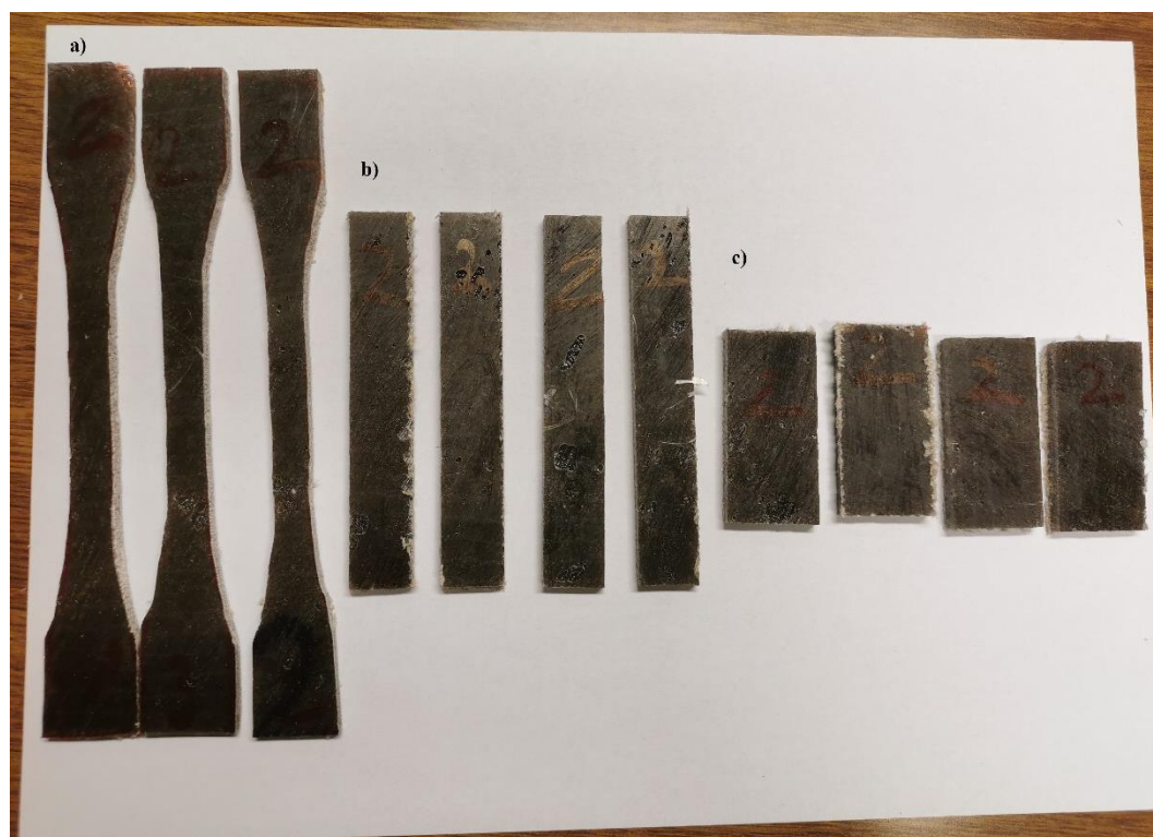
Slika 15. Pripremljeni ispitna tijela; a) epruvete za statičko rastezno ispitivanje, b) epruvete za savojno ispitivanje, c) epruvete za ispitivanje prividne međuslojne smične čvrstoće.
