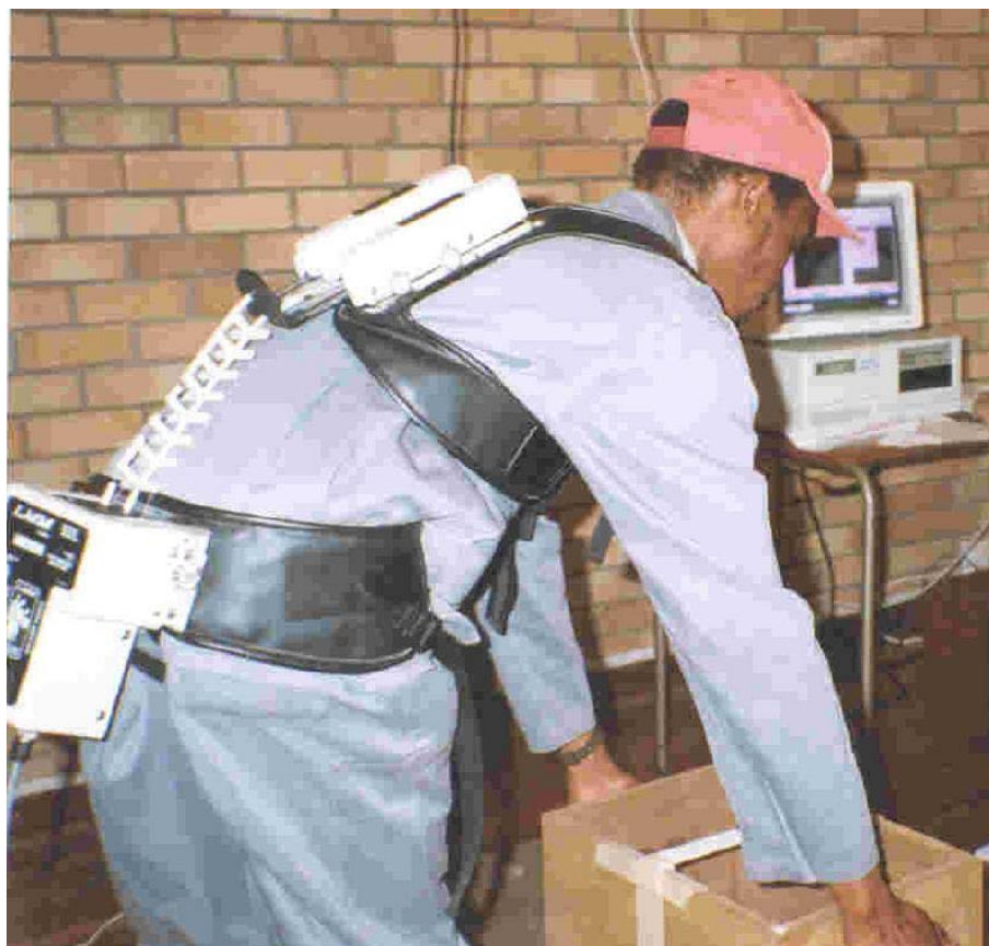
Slika 15. Uređaj za praćenje pokreta leđa [10]
