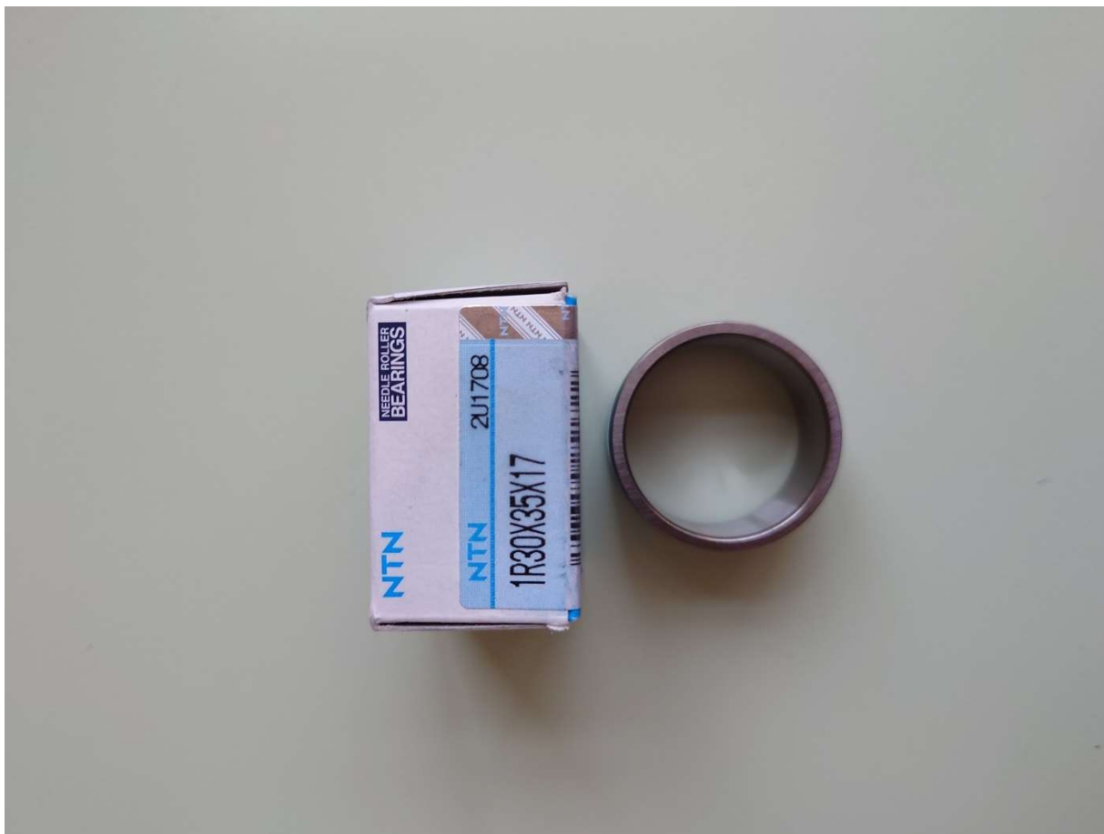
Slika 21. Prsten ležaja od čelika 100Cr6
