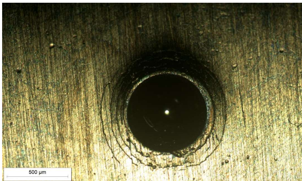
Slika 30. Mjesto ispitivanja prionjivosti prevlake na prstenu P2
