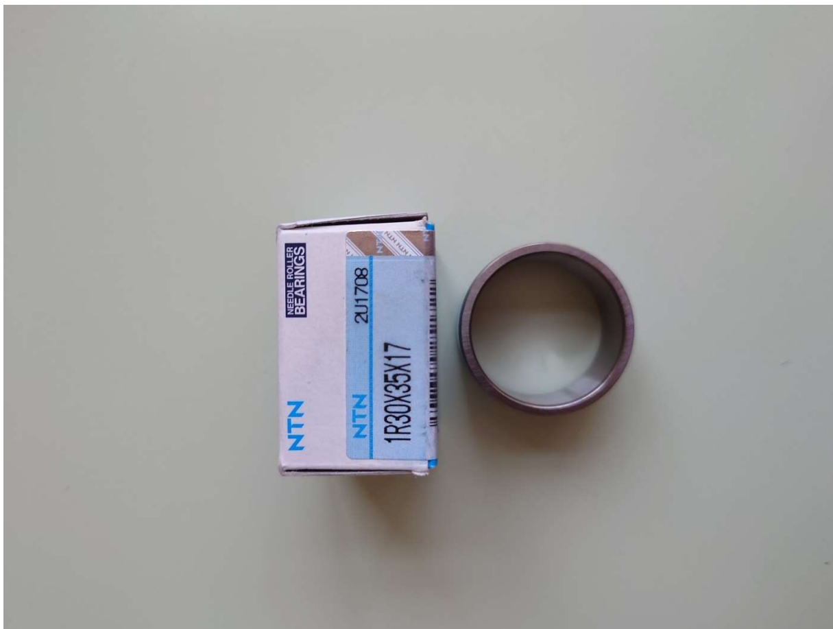
Slika 21. Prsten ležaja od čelika 100Cr6
