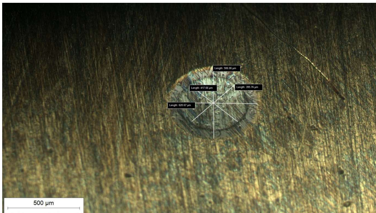
Slika 33. Mjesto ispitivanja prstena P2 kalotestom
