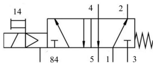
Slika 7. Blok MFH-5-1/8 ventila
