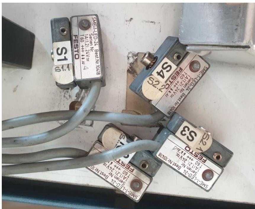
Slika 13. Induktivni senzori za poziciju klipa SME-1-LED-24
