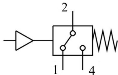
Slika 12. Tlačna sklopka PE-1/8-1N [9]
