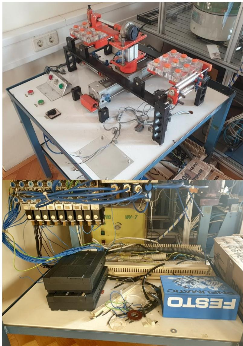
Slika 2. Stanica pneumatskog manipulatora u zatečenom stanju
