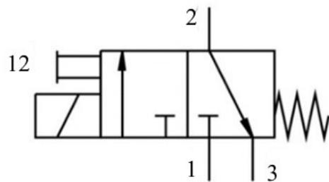
Slika 8. Pneumatski 3/2 ventil s elektromagnetskom zavojnicom
