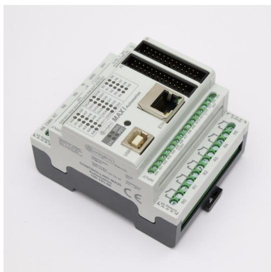
Slika 16. Upravljački uređaj CONTROLLINO MAXI Automation [12]
