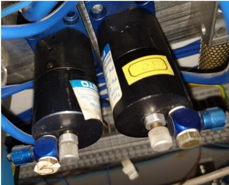
Slika 10. Glava za kontrolu vakuuma [8]
