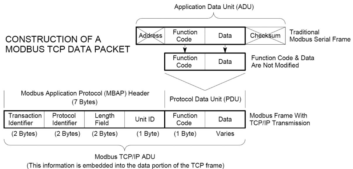
**Slika 26. Struktura jednog Modbus TCP/IP paketa [21]**
