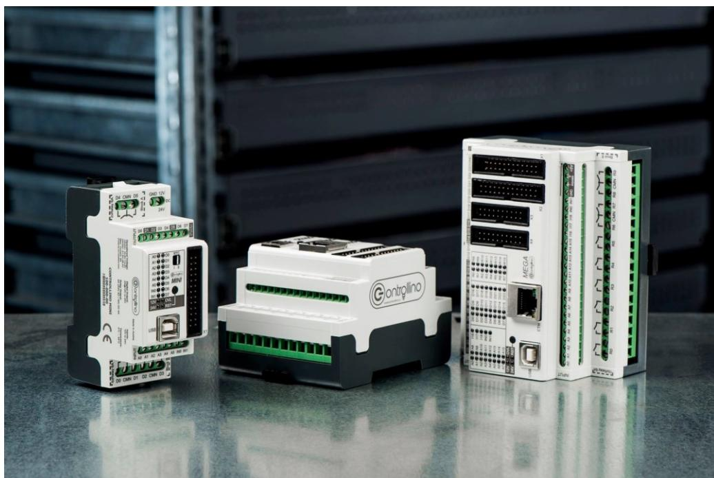
Slika 15. Upravljački uređaji: CONTROLLINO MINI, MAXI i MEGA [10]
