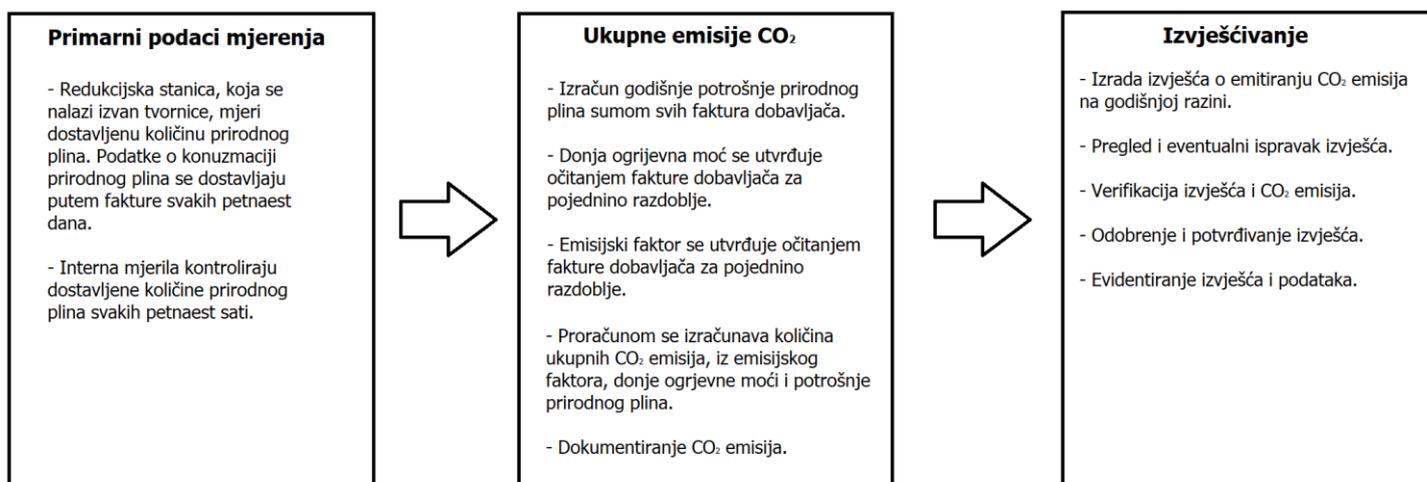
Slika 13. Prikaz procedure za slijed aktivnosti od mjerenja do izvješćivanja
