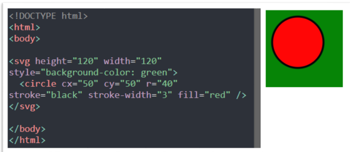
Slika 3.4 Generiranje SVG kružnice
