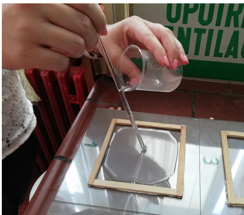
Slika 5.5 Lijevanje otopine u stakleni kalup
