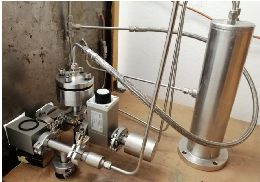
Slika 5.29 Uređaj za mjerenje permeabilnosti
