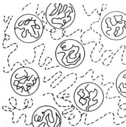
Slika 3.4 Potpuno nemješljiva polimerna mješavina (polimer A – puna linija; polimer B – isprekidana linija) [128]
