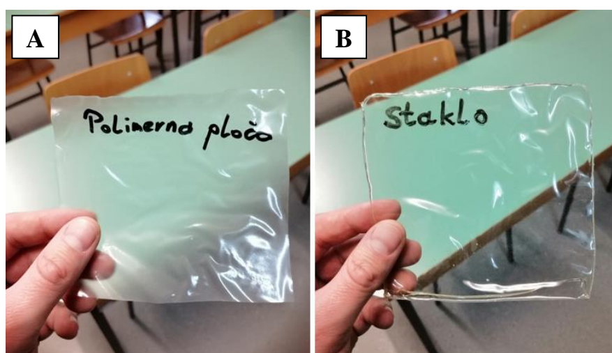
Slika 5.2 (A) Mutni film dobiven lijevanjem otopine na hrapavu polimernu podlogu; (B) proziran film dobiven lijevanjem otopine na staklo
