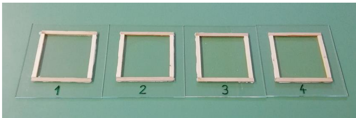
Slika 5.4 Kalupi za izradu filmova postupkom lijevanja otopine
