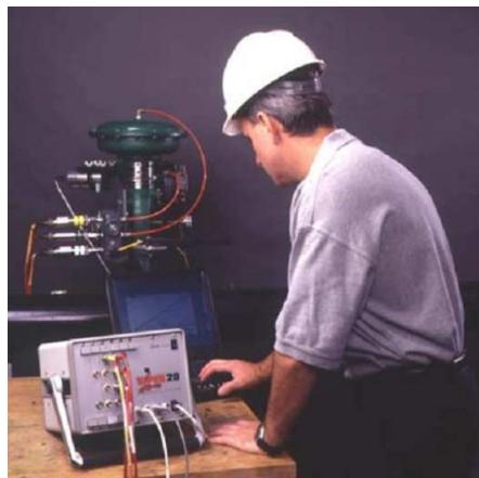
**Slika 7.7** CRANE Nuclear VIPER20 testna oprema
