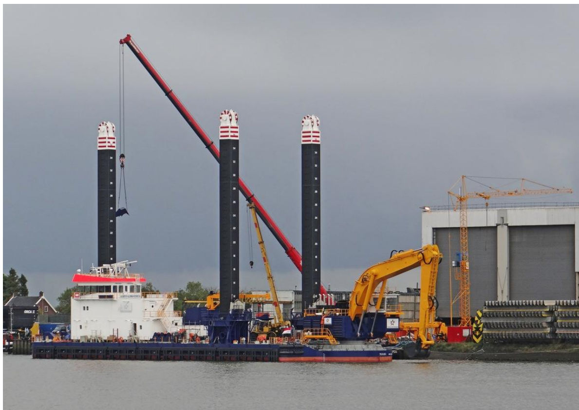
Slika 2-2 IHC Backhoe dredger u brodogradilištu
