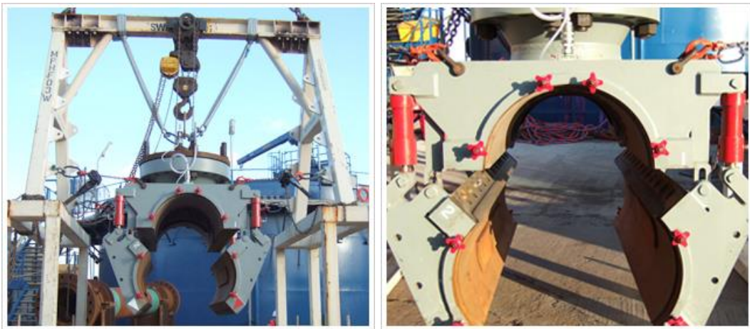
Slika 7.15 Primjer podvodne ESR obujmice prije ugradnje [59]
