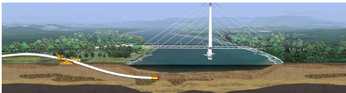
Slika 3.13 Horizontalno usmjereno bušenje [67]
