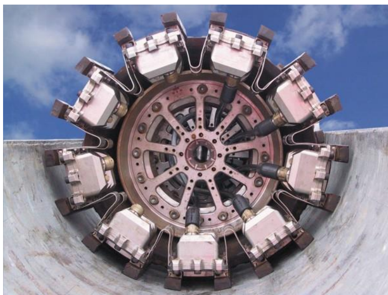
Slika 6.14 Ultrazvučni uređaj za mjerenje promjena stijenke plinovoda [48]
