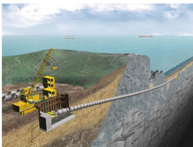
Slika 3.16 Profil horizontalno usmjerenog bušenja [67]
