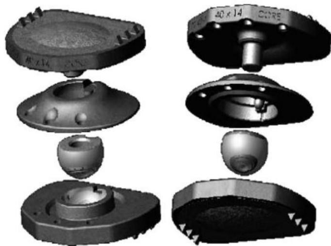
Slika 37. Dijelovi FlexiCore proteze [28]
